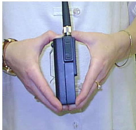
Le casier à piles/l'accu et la radio sont serrés en bas jusqu'à ce que le casier à piles/l'accu s'enclique.
